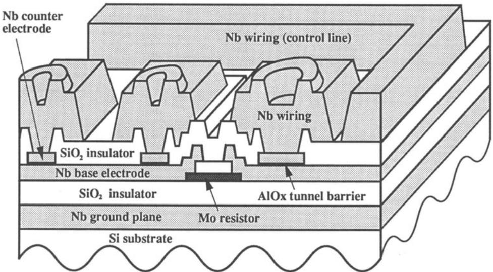
(d) Deposition and patterning of wiring layer
