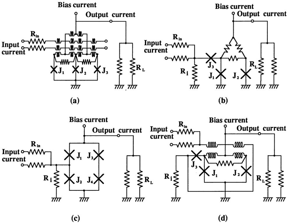
Fig. 2 Equivalent circuit of logic gates. (a) JIL, (b) RCJL, (c) 4JL, (d) MVTL.
